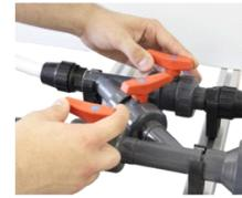
→ Comienza a circular el agua. Con la válvula que tenemos en la parte superior del depósito de salida inferior, regulamos relación agua/aire que queremos en dicho depósito.
