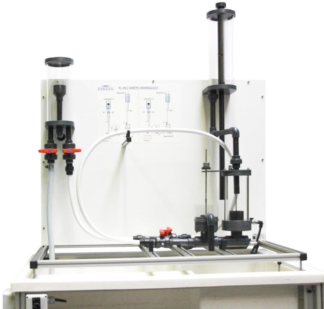
El equipo FL09.2 se trata de un equipo con el que se pretende demostrar y estudiar el fenómeno conocido como *golpe de ariete*, dicho fenómeno es el que se produce debido al cierre rápido del paso del agua a través de una tubería. El diseño del equipo se realiza con especial hincapié en el ámbito didáctico, por ello se suministra con elementos variables, para conseguir realizar una mayor cantidad de ensayos para una mejor comprensión por parte del alumno.
